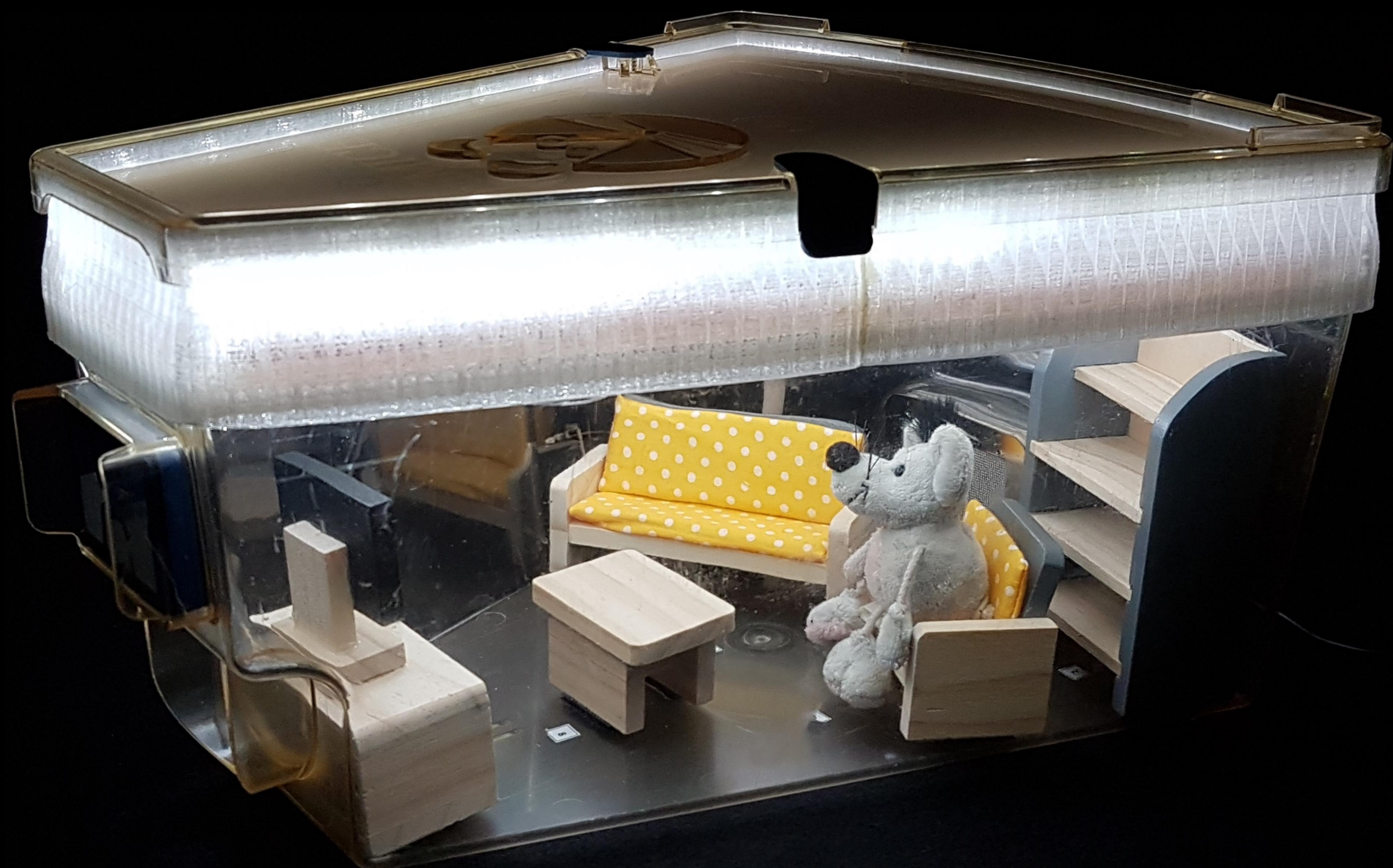
Abb. 1: Prototyp des Beleuchtungssystems (weißer Aufsatz) auf einem bestehenden Käfigmodul. Links offen und Box mit Elektronik, sowie LED-Streifen sichtbar. Rechts geschlossen abgebildet.
